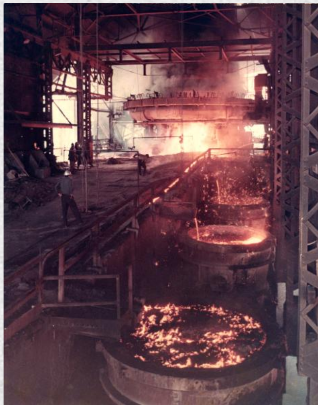
Fig. 1. Federico Espinosa. Proceso de vaciado de arrabio a las ollas. Ca. 1967. Monterrey, N.L., México D.R. © 40317 Archivo General de la Nación. Parque Fundidora, O.P.D. Fototeca Nuevo León - CONARTE, Fondo: Fundidora. Impresión en color 8x10".
